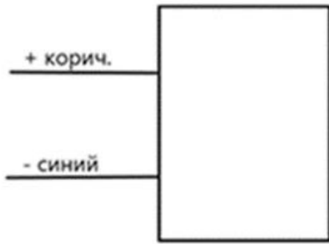
Рисунок 2- Схема подключения к сети постоянного тока (Постоян ток., 3-15 В, 1А)
